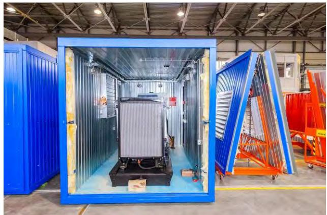
Быстроотъемная торцевая стена для удобства монтажа / демонтажа оборудования, ремонта ДЭС
